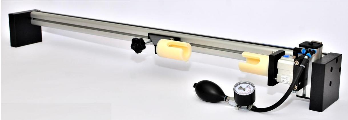
Die Ultraschall-Messvorrichtungen realisieren neben der Ankopplung von Ultraschall-Geber und Ultraschall-Empfänger an den unterschiedlichsten Messobjekten vor allem eine konstante Andruckkraft über die Messdauer.
