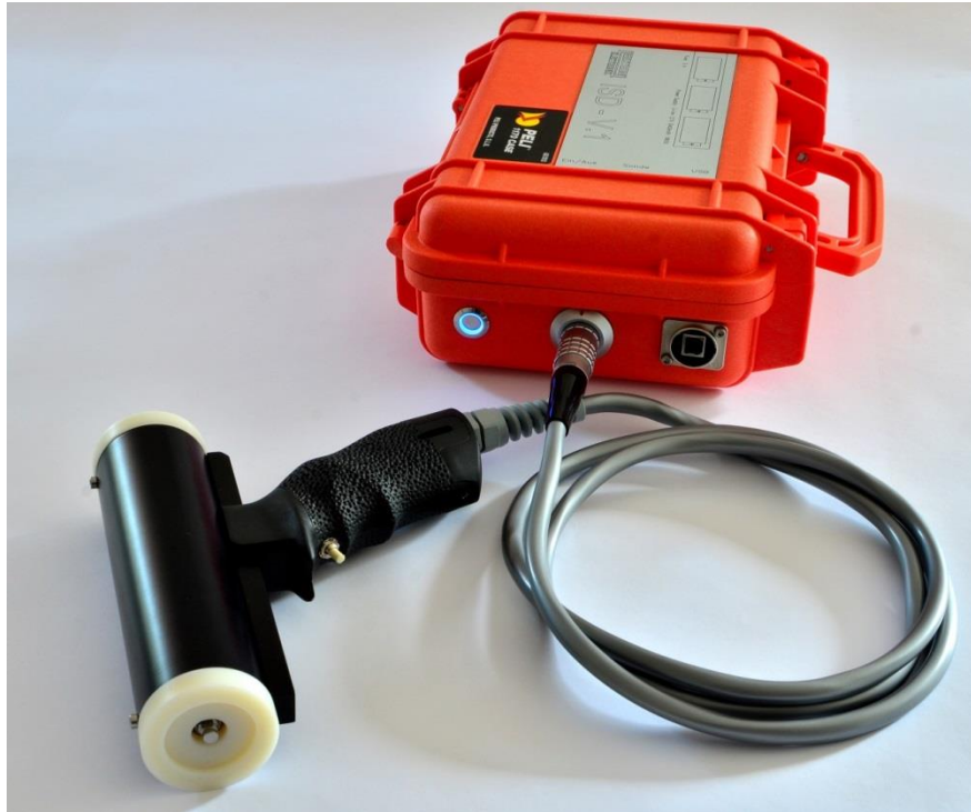
Handgerät (im Vordergrund) mit Impaktor und Kraftsensor sowie abgesetzter Elektronik-Box
