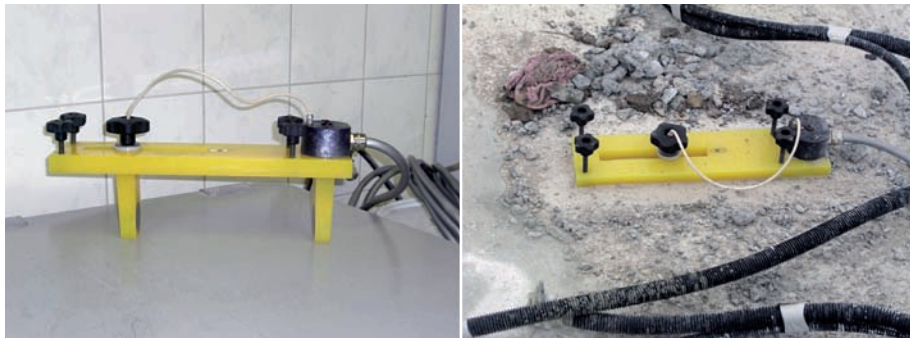
Bild 2: Tauchsonde komplett (links) und eingebaut (rechts)
